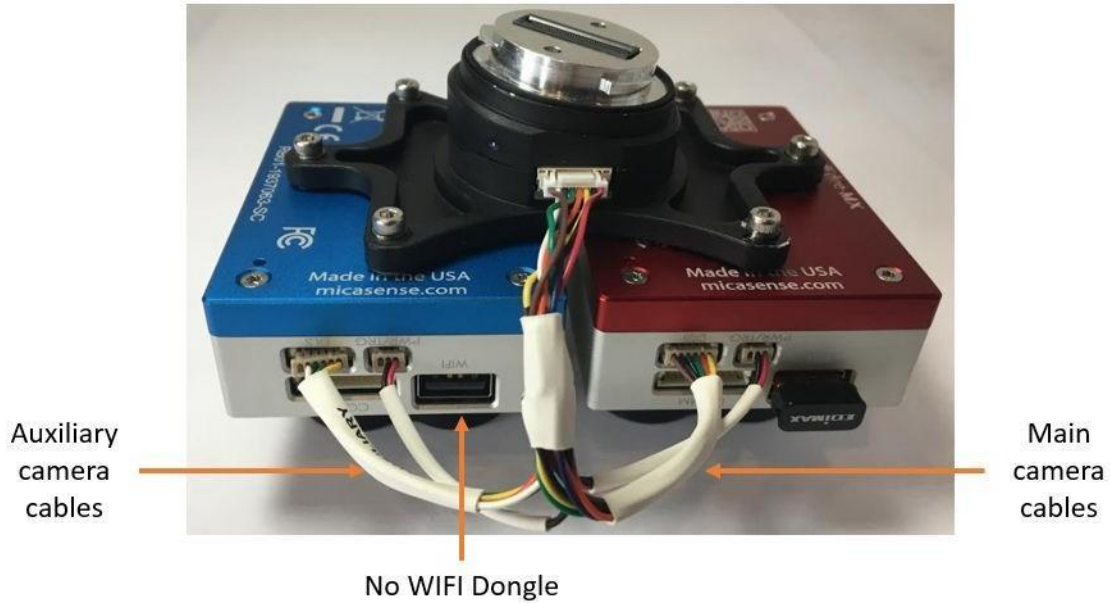
듀얼 카메라 시스템 마운트, RedEdge-MX 및 RedEdge-MX Blue 간의 연결
